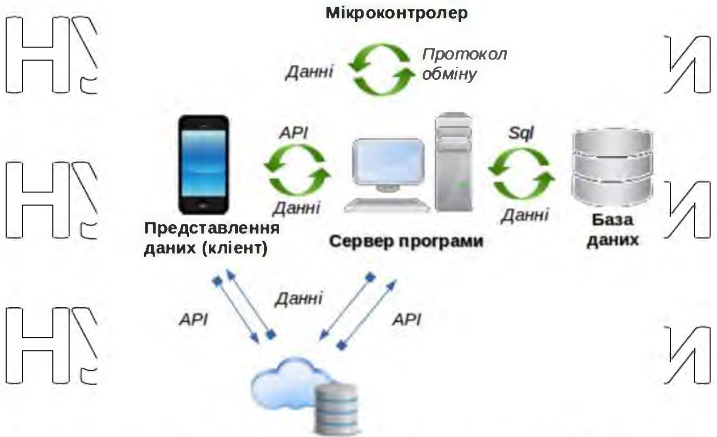
Рисунок 2.4 – Схема взаємодії всіх складових моделі на основі даних з IoT
