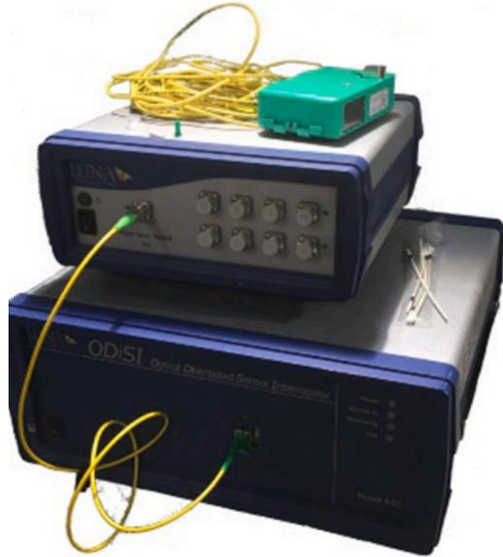
Рис. 11 Приклад оптичного рефлектометра зворотного розсіювання ODiSi [44]
