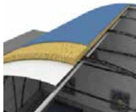
Рис. 77. Схема каркасної будівлі приміщення для утримання племінного стада кролів
