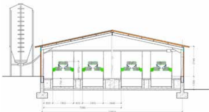
Рис. 77. Схема каркасної будівлі приміщення для утримання племінного стада кролів
