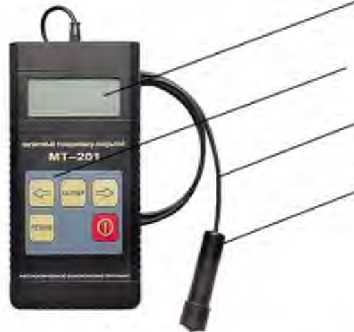
1 - рідкокристалічний дисплей, 2 - пульт управління, 3 - з'єднувальний кабель, 4 - індукційний перетворювач.
