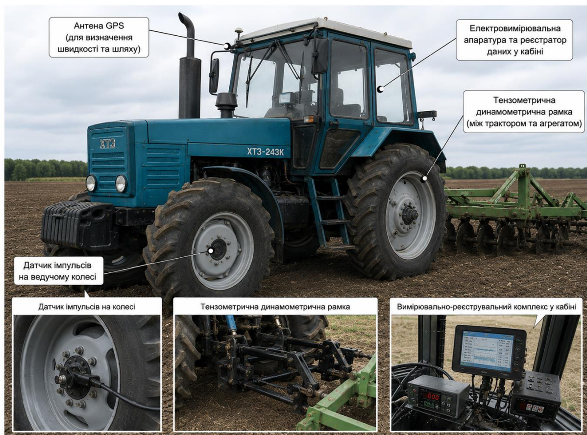
Рисунок 2.19 – Загальний вигляд тензотрактора ХТЗ-243К, обладнаного вимірювально-реєструвальною апаратурою для визначення тягового опору ґрунтообробного агрегату.
