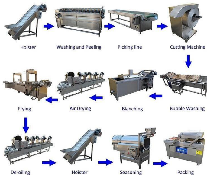
Рисунок 1.1 – Принципова апаратурно-технологічна схема лінії виробництва картопляних чіпсів
