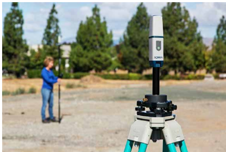
Рис. 3.2 GPS приймач Sokkia GCX3
