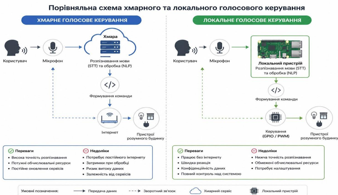
Рисунок 3 - Порівняльна схема хмарного та локального голосового керування
