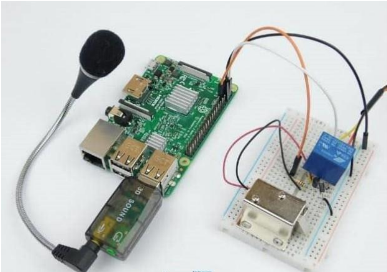
Рисунок 2.1 - Приклад локальної системи голосового керування на базі Raspberry Pi
