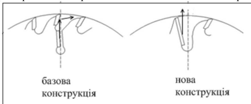
Рис. 2. Схема відмінності запропонованої конструкції пилки
