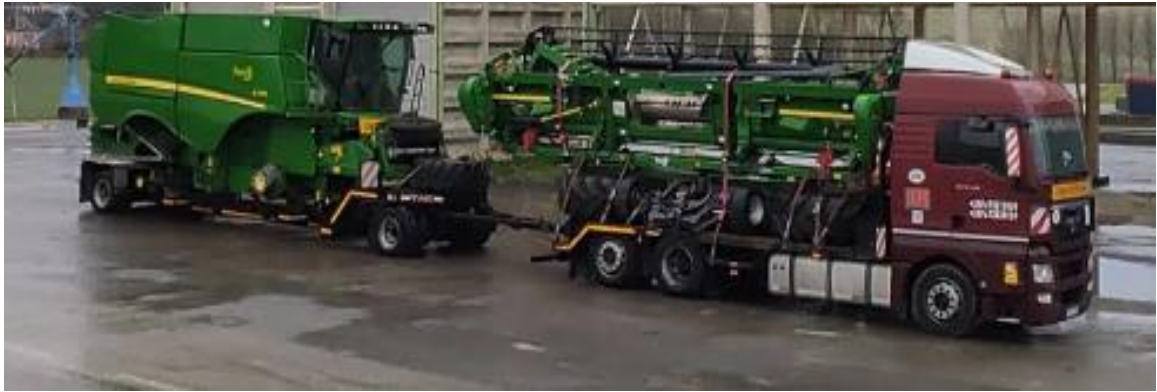
Рис. 2.4. Дволанковий автопоїзд на перевезенні негабаритних вантажів
