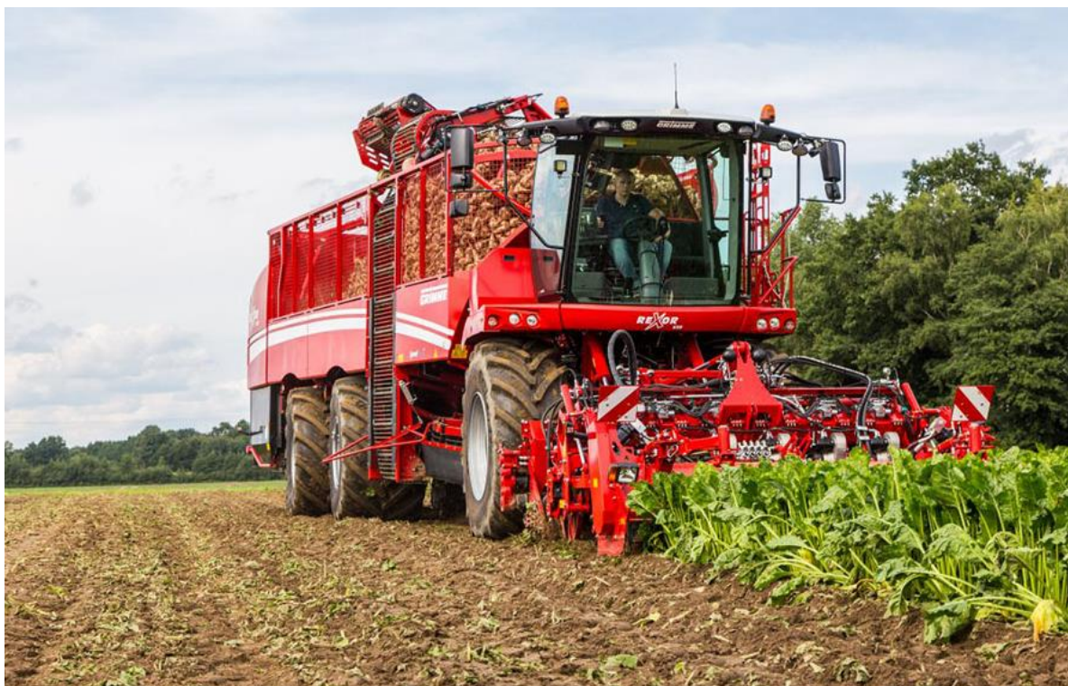
Рис. 1.5. Використання самохідного комбайна для збирання цукрових буряків в рамках однофазного збору врожаю
