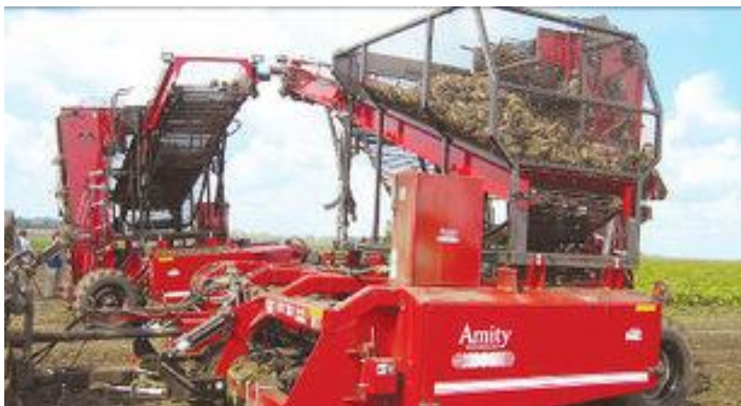
Рис. 2.5. Причипний бурякозбиральний комбайн «Wic»
