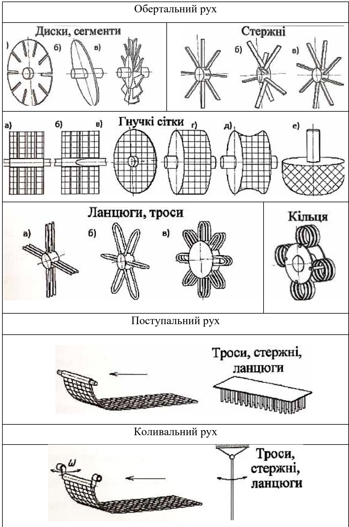
Рис. 2.11. Принципи роботи пристроїв для очищення коренеплодів
