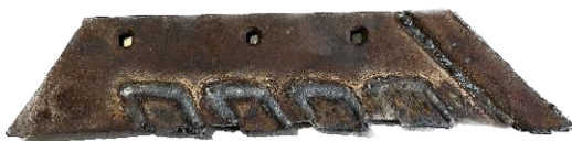
Рисунок 3 – Плужний леміш з постановкою компенсуючих вставок
