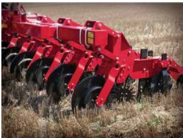
Рис.1.19. Ротаційна борона у складі комбінованого агрегату
