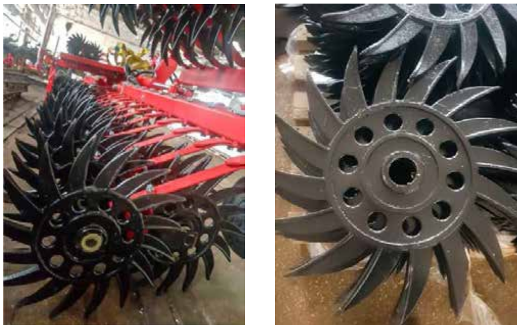
Рис.1.18. Ротаційна борона «Динар», виробництва ПАТ «Лозовські машини»
