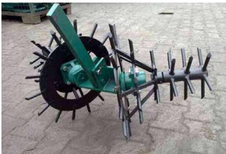
Рис. 1.10. Ротаційна борона для роботи в умовах гребеневого землеробства
