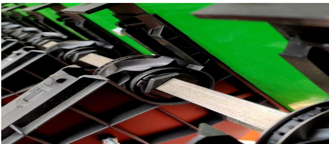
Рис. 2.6. Катушковий висівний апарат зернотукової сівалки
