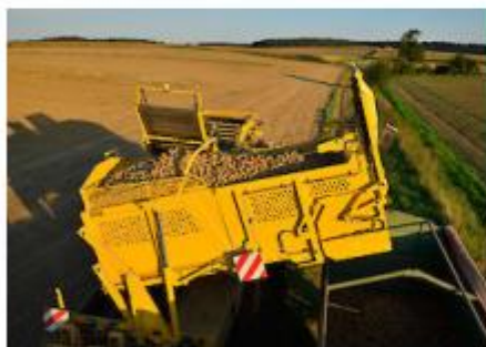
Рис. 1. Бункер місткістю 7,5 т дворядного причіпного картопле-збирального комбайна Keiler 2 компанії ROPA.
