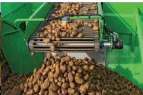
Рис. 2. Чотирирядний самохідний картоплезбиральний комбайн AVR Puma 3 обладнаний 8-тонним бункером.
