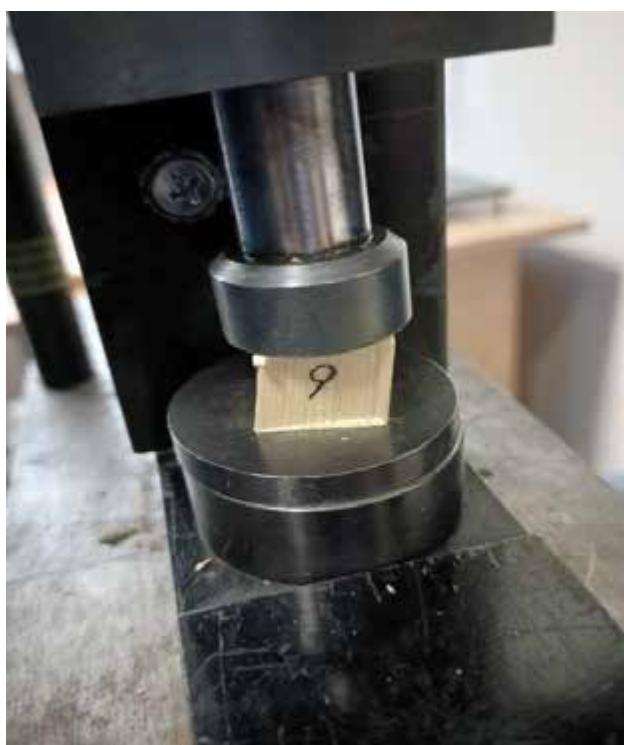
Рис.3.4. Дія навантаження на зразок
