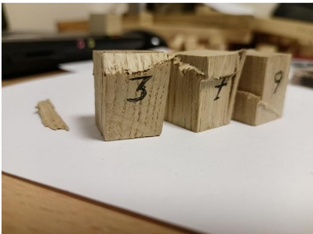
Рис.3.10. Соснові зразки № 3,7,9 - 20x20x20
