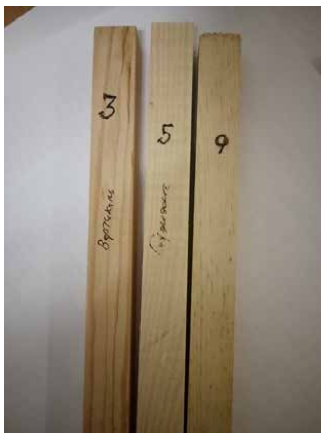
Рис.3.2. Соснові зразки на згин
