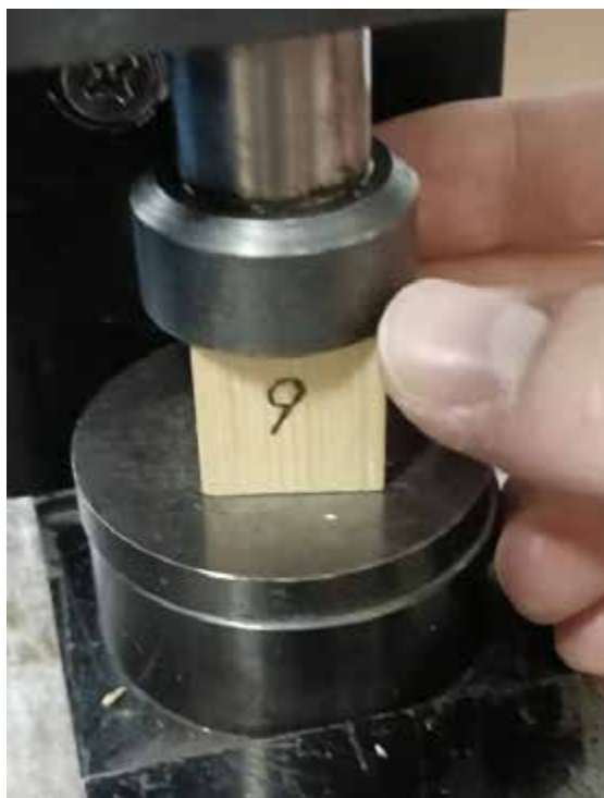
Рис.3.3. Кріплення соснових зразків на стиск
