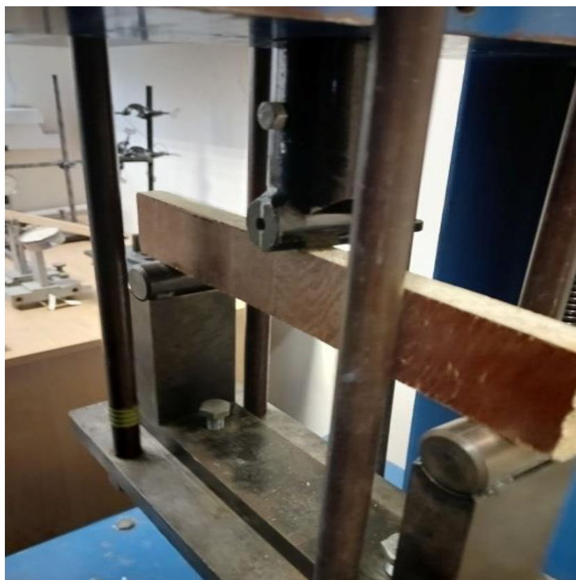
Рис.3.7. ДСП зразок на згин
