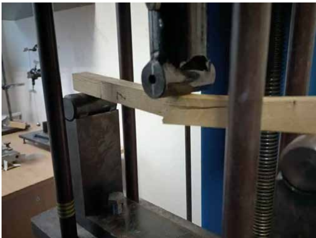
Рис. 3.6. Соснові зразки на згин
