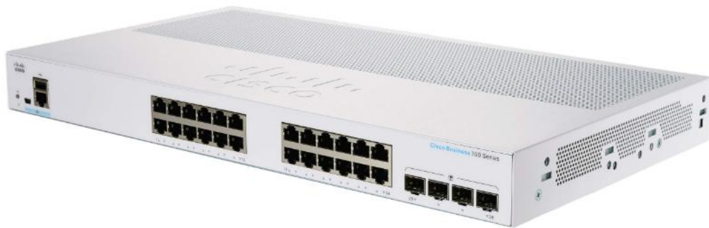
Рисунок 3.1 – Комутатор Cisco CBS350-24T-4G
