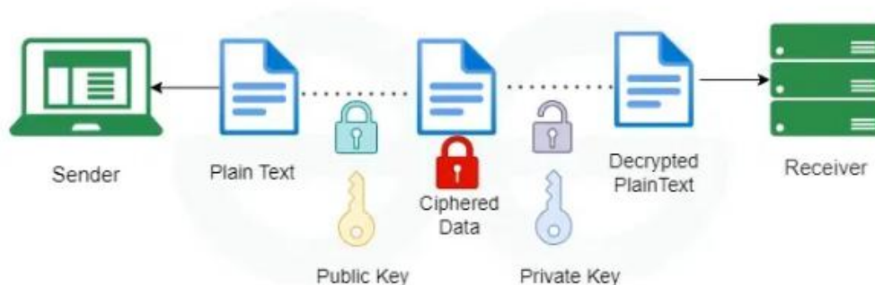
Рисунок 2.3 – Робота асиметричної криптографії
