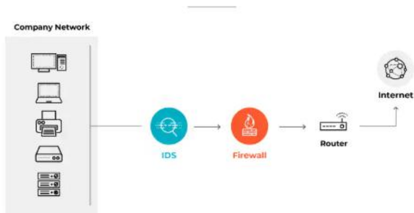
Рисунок 2.7 – Робота системи виявлення вторгнень
