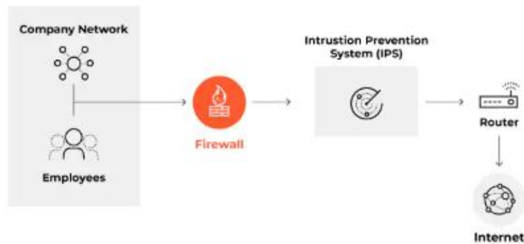
Рисунок 2.8 – Робота системи запобігання вторгнень
