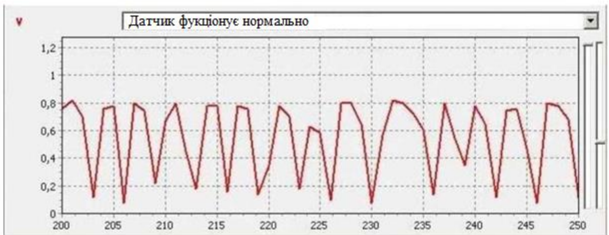
Рисунок 6 - Діаграма вібрацій датчика концентрації кисню під час роботи
