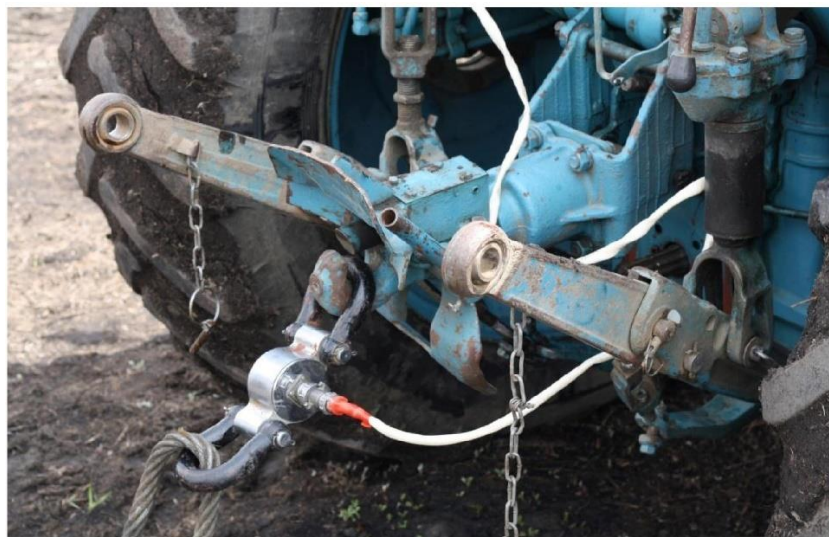
Рисунок 3.6 – Вимірювання тягового зусилля
