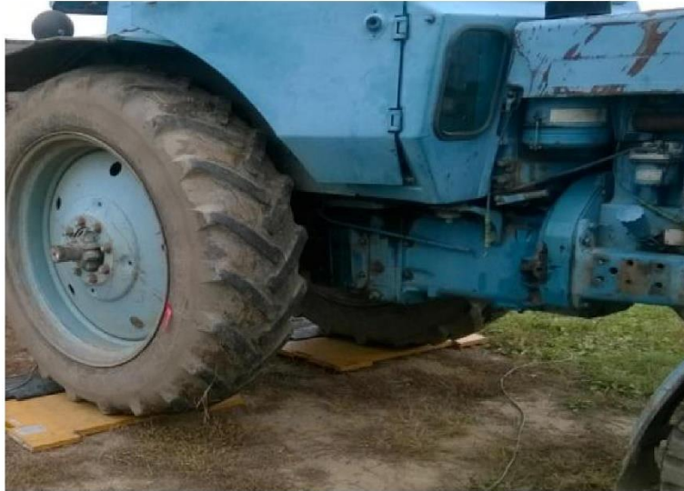
Рисунок 3.8 – Фрагмент вимірювання ваги трактора, що припадає на колеса
