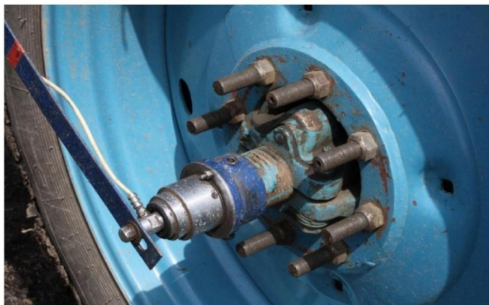
Рисунок 3.5 – Вимірювання частоти обертання ведучих коліс трактора
