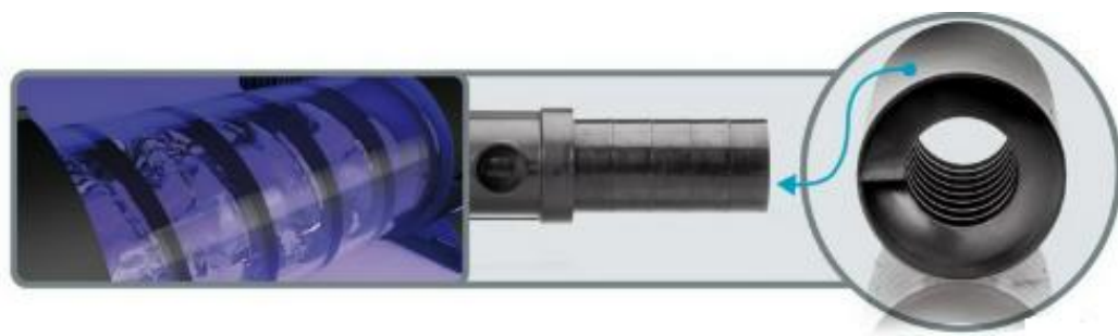
Рис. 3.3.1. Принцип роботи УФ-стерелізатора
