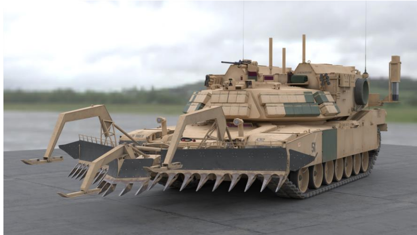
Рис. 1.20. Приклад тральної розмінувальної машини M1150 AVV
