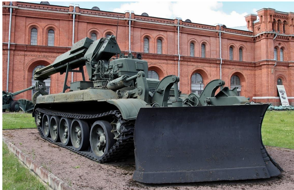
Рис. 1.12. Інженерна машина для розгородження
