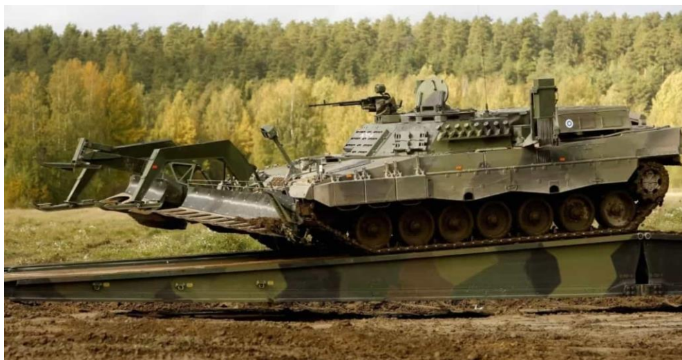
Рис. 1.17. Leopard 2R, бойова машина розмінування, створена на базі танка Leopard 2A4
