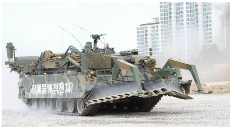
Рис. 1.27. Тральна розміновувальна машина K600 Rhino
