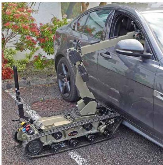
Рис. 1.24. Дистанційно керований робот Avenger LT UGV
