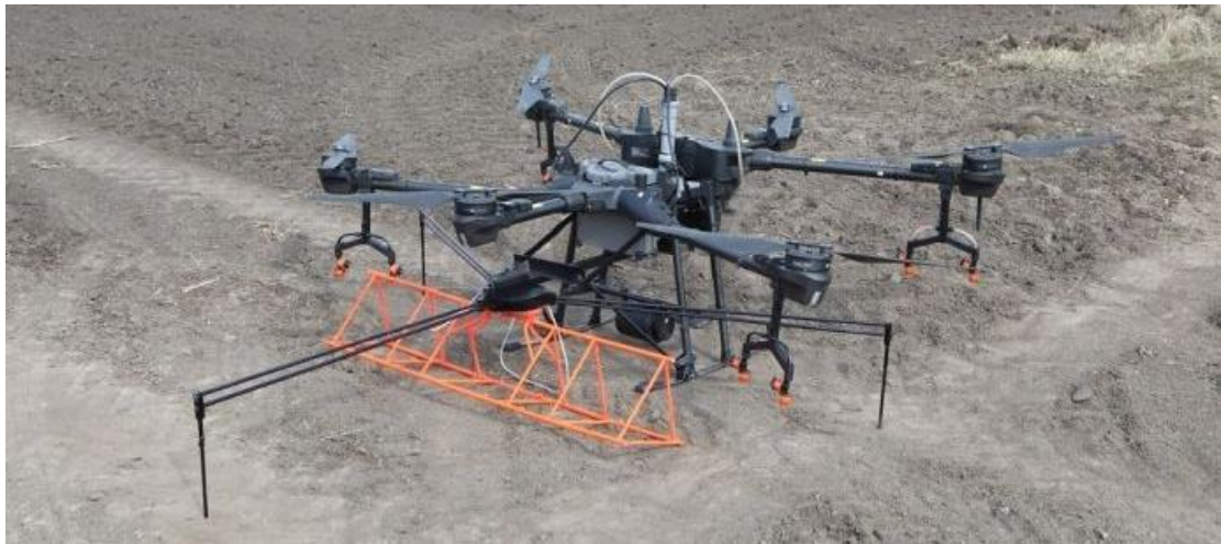
Рис. 1.11. Дрон детектор для виявлення ВВП
