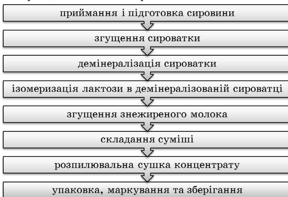
Рис. 5.3. Технологічний процес виробництва концентрату «Лактобел-ЕД»
