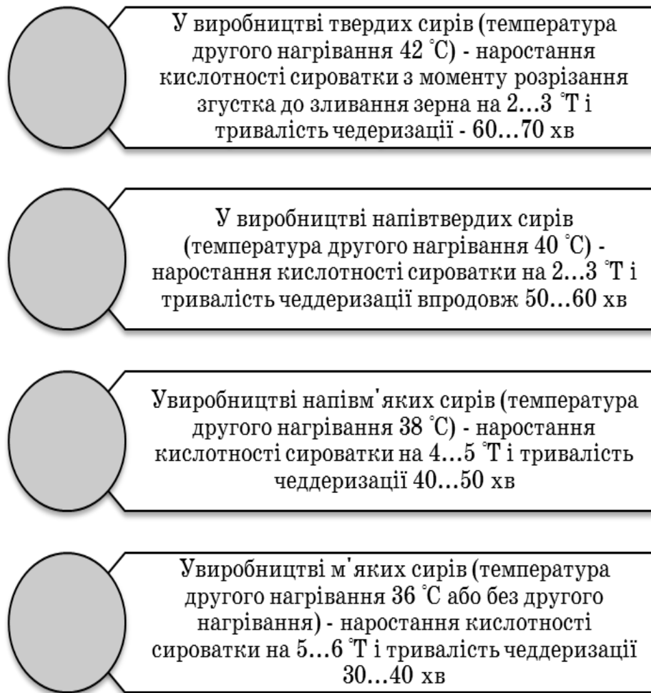
Рис. 8.31. Показники, які повинна забезпечити закваска при виробництві сиру Pasta Filata
