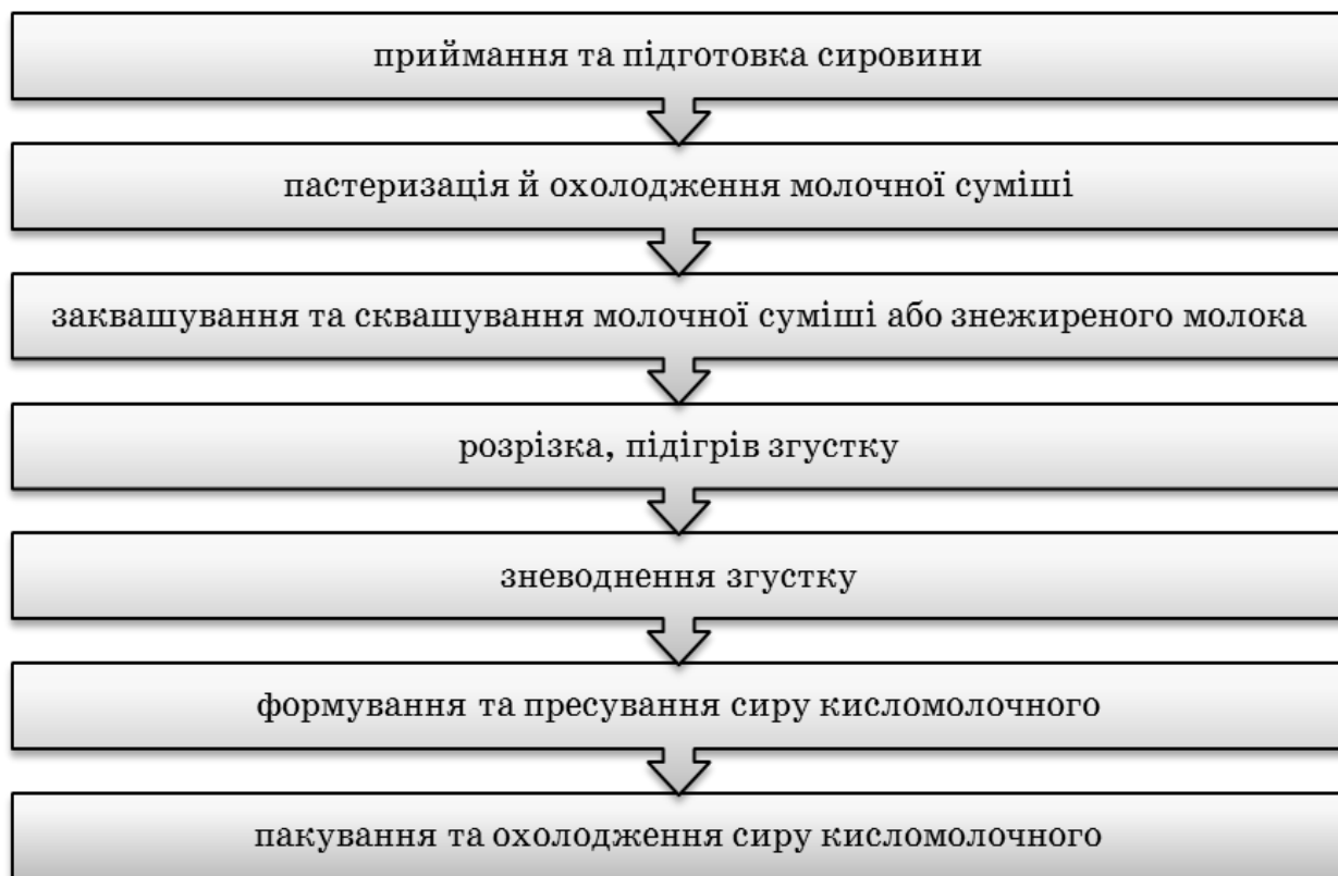
Рис. 4.31. Послідовність технологічних операцій виробництва сиру кисломолочного на лінії «OVRAM»
