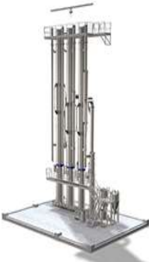
Рис. 5.9. Вакуум-випарна установка з падаючою плівкою Tetra Pak TVR
