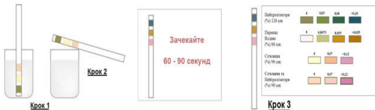
Рис. 2.21. Візуалізація способу застосування тест-смужки Milk Security
