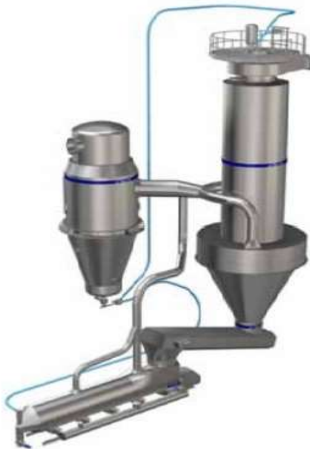
Рис. 9.12. Розпилювальна сушарка Tetra Magna Prolac Dryer для молочної сироватки
