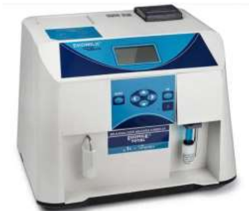
Рис. 2.15. Аналізатор молока ультразвуковий ЕКОМІЛК Bond
