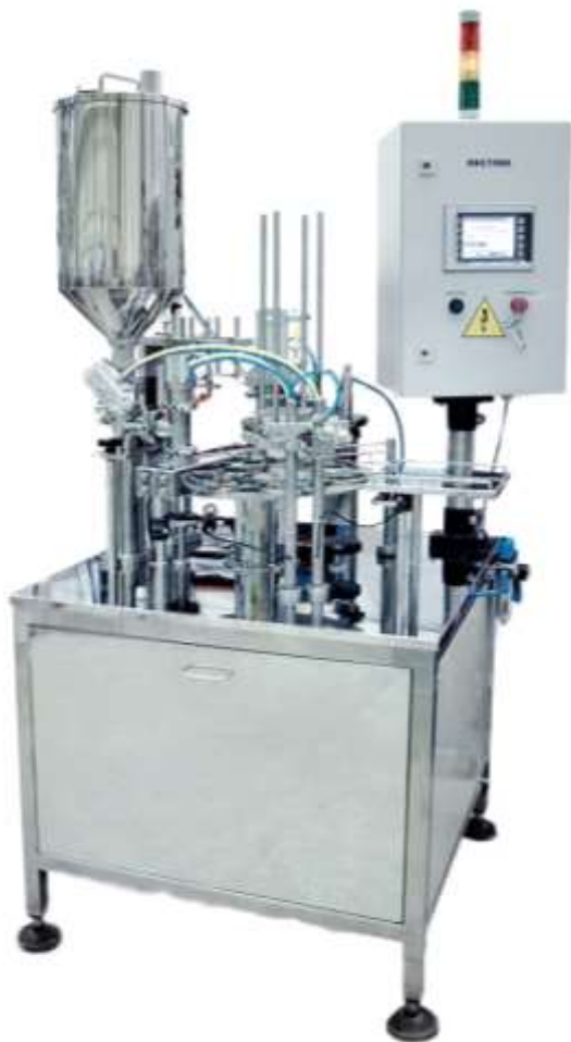
Рис. 4.47. Автомат для фасування в полістиролові стаканчики
