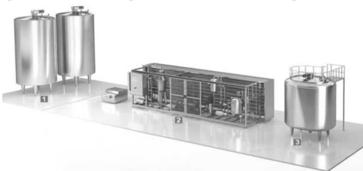
Рис. 4.7. Лінія DONIDO виробництва УВТ-обробленого молока:
