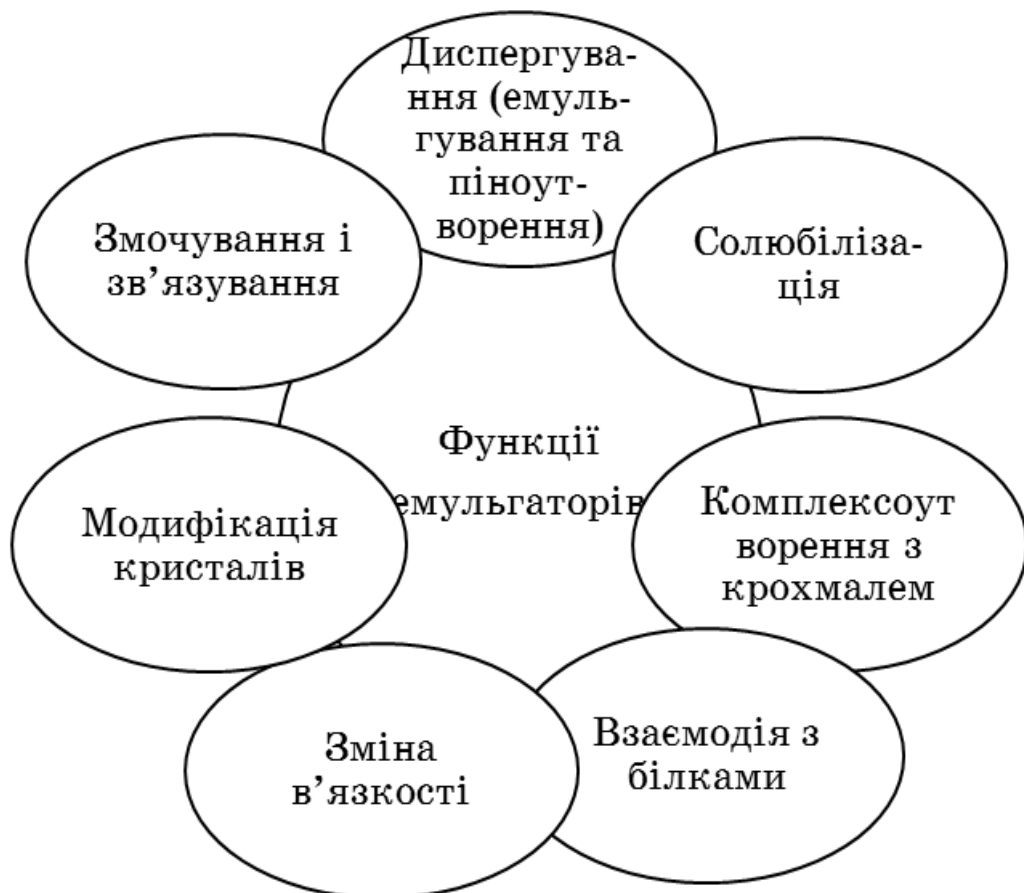
Рис. 3.16. Основні технологічні функції емульгаторів в харчових системах
