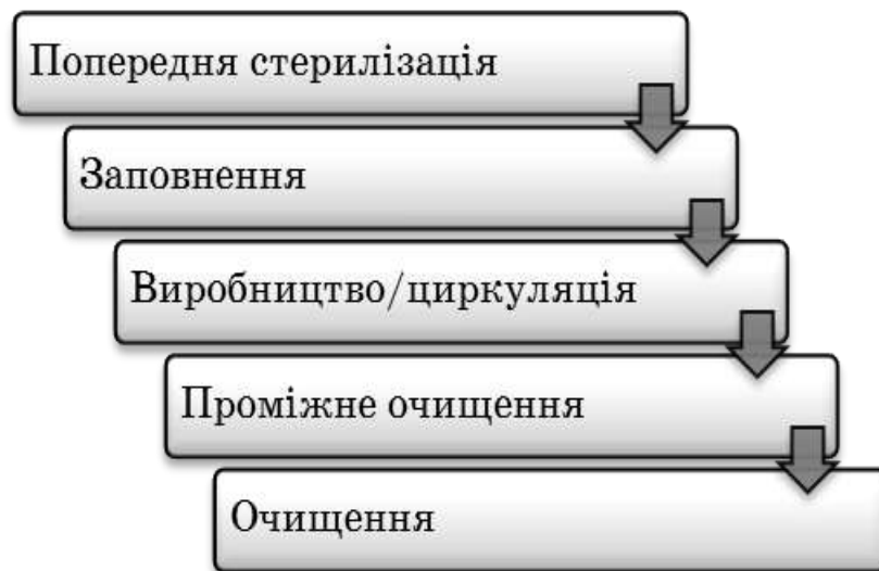
Рис. 2.24. Процеси, що проводять в установці Tetra Therm Lacta
