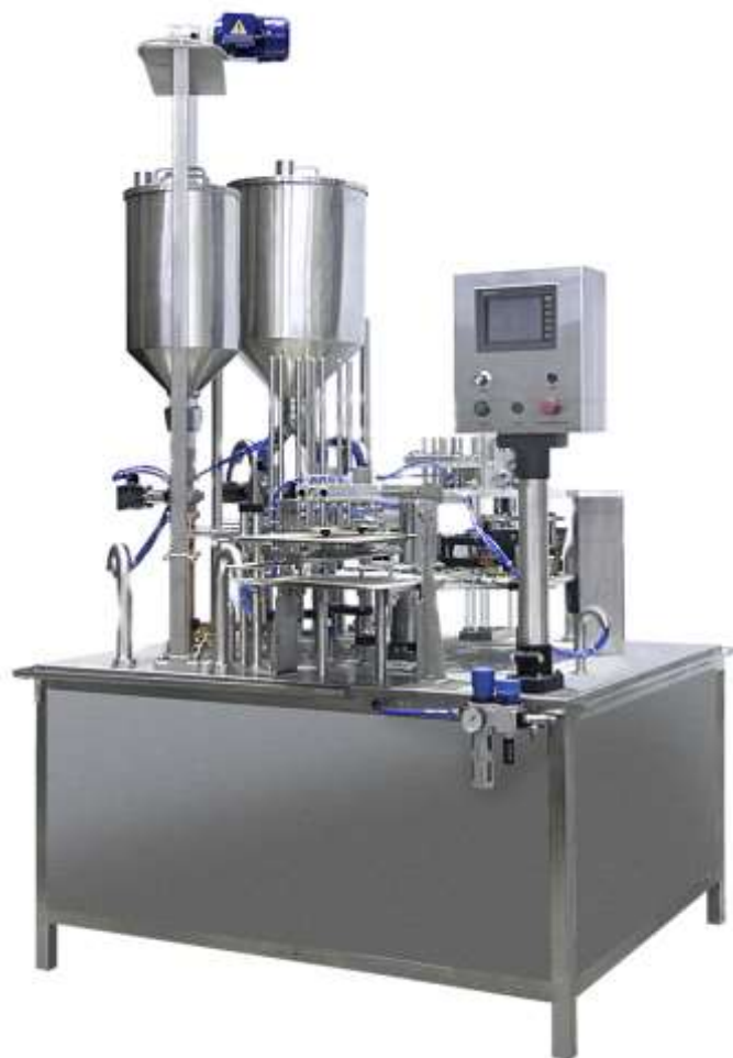
Рис. 4.51. Автомат дворядний для фасування в полістиролові стаканчики
