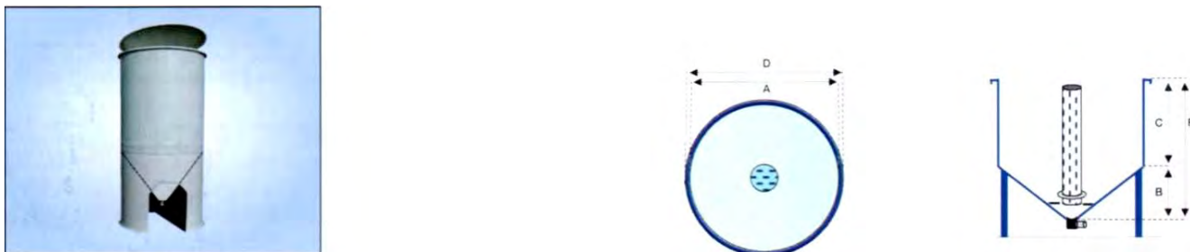
Мал. 47. Круглий циркуляційний басейн конічної форми, на ніжках з шаровим краном із ПВХ, ухилом дна 45^{\circ}
