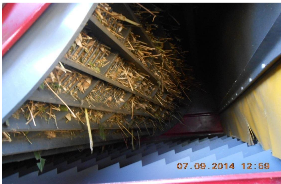
Рис. 2.13. Процес "залипання" підбарабання молотарки під час збирання білого люпину
