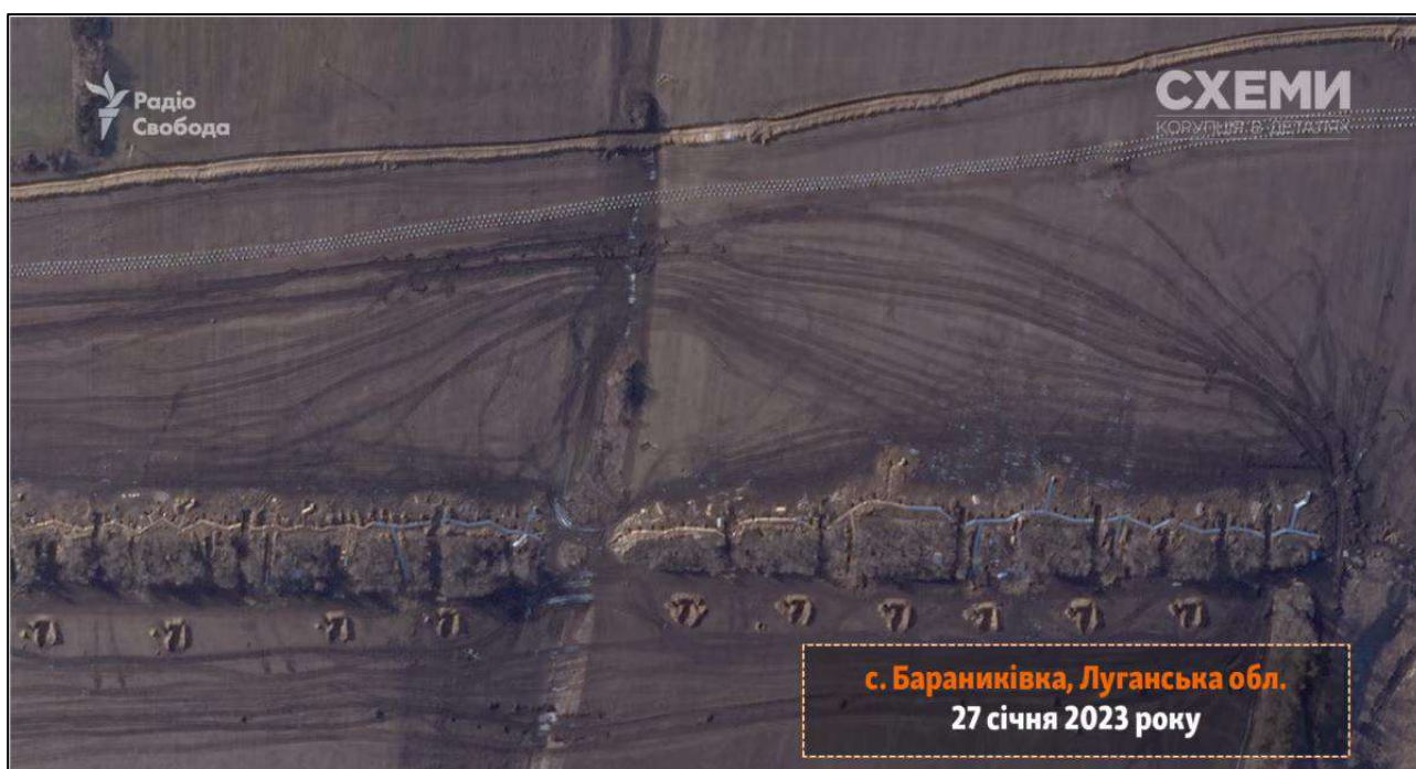
Рис. 2.5.4— Пошкодження ґрунтового покриву внаслідок будівництва фортифікацій та використання військової техніки на прикладі с.Бараниківка [36]
