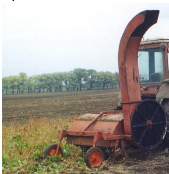
Рис. 1. Гичкозбиральна машина з ротаційним ріжучим апаратом, фронтально навішена на колісний трактор:
