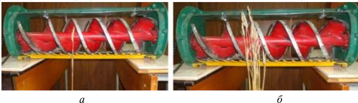
Рис. 2. Різання одного стебла (а) і групи стебел (б) ріжучим апаратом
