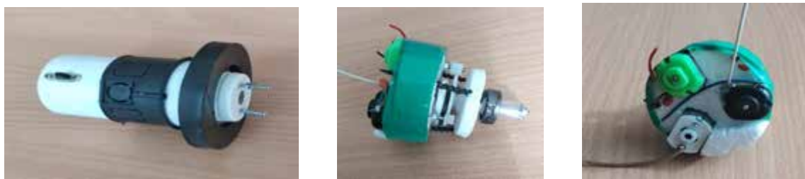
Рис. 3. Дослідний зразок двигуна – колеса ( а) зовнішній вигляд; б), в) блок двигунів з одним редуктором)
