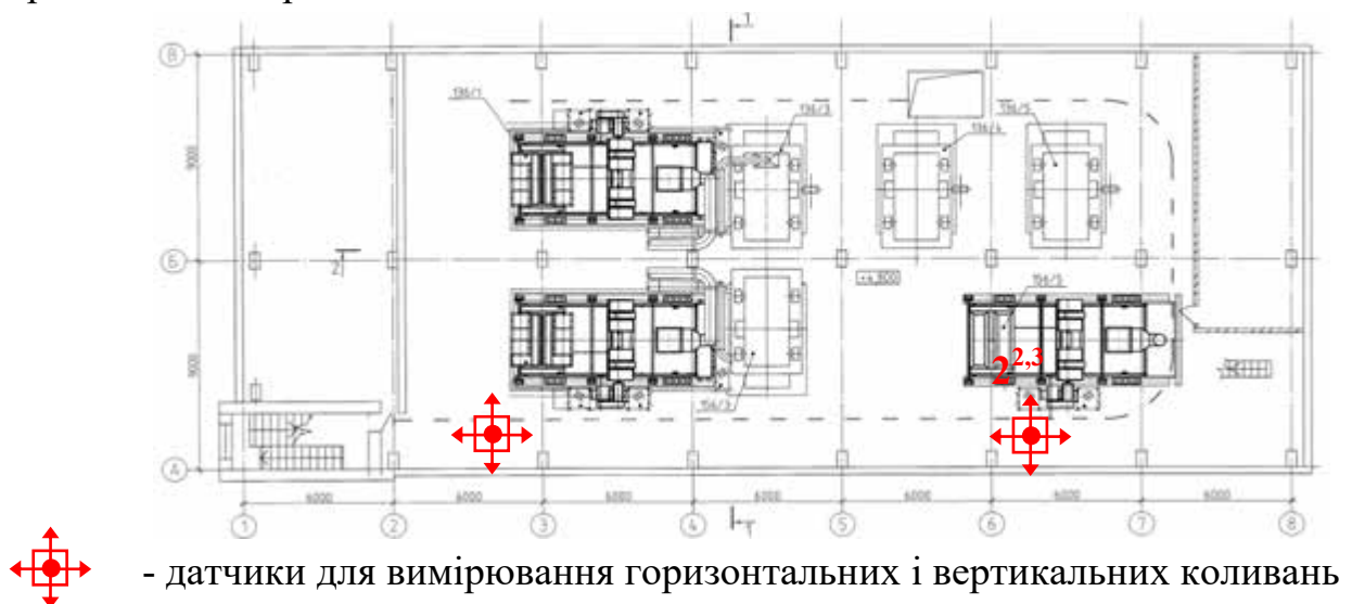
Рис. 3. Розстановка датчиків (акселерометрів) на відм. +4.800 біля грохотів
