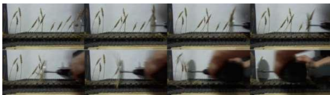
Рис. 7. Розкадрування процесу зрізування стебел при куті нахилу диска 80°
