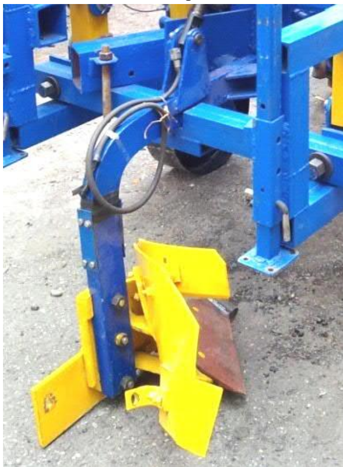
Рис. 1. Загальний вигляд секції плуга з наклеєними на стійку тензодатчиками
