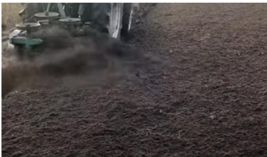
Рис.3.7 Робота роторного плуга та стан ґрунту після виконання оранки
