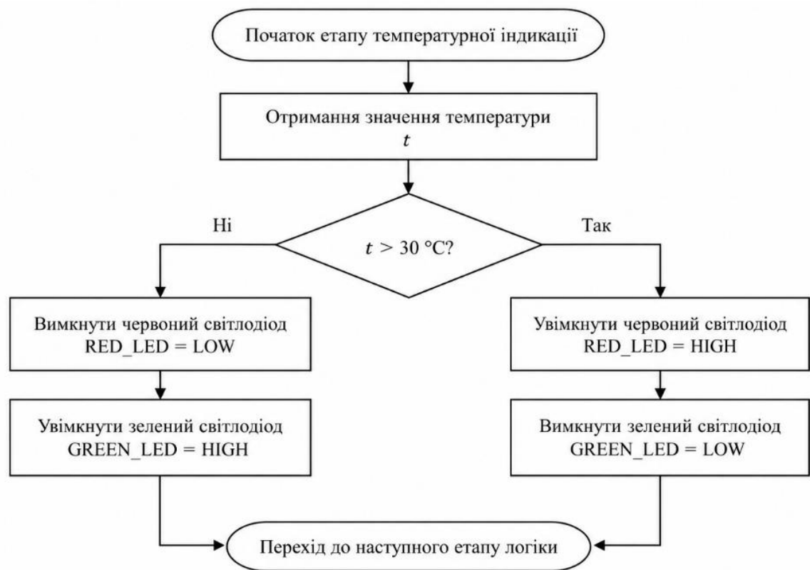
Рисунок 3.5 – Блок-схема логіки температурної індикації
