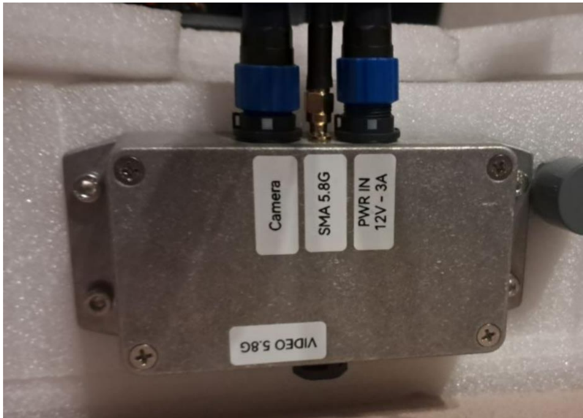
Рисунок 2.6 – Підсистема аналогового FPV-контролю фізичної моделі
