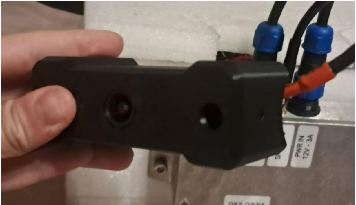
Рисунок 2.7 – FPV-камера у 3D-друкованому корпусі
