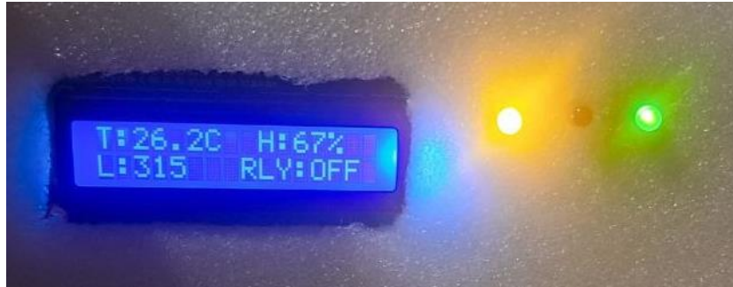
Рисунок 3.7 – Тестування роботи LCD-дисплея та світлодіодної індикації
