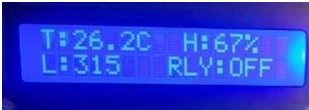
Рисунок 3.4 – Відображення температури, вологості та освітленості на LCD-дисплеї
