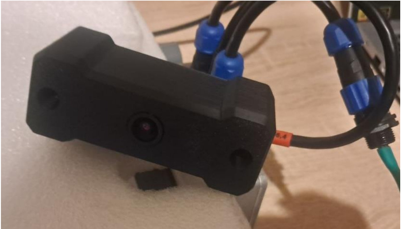
Рисунок 3.14 – FPV-камера у 3D-друкованому корпусі
