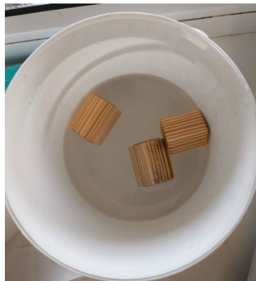
Рис. 3.3. Контакт зразків з водним середовищем.
