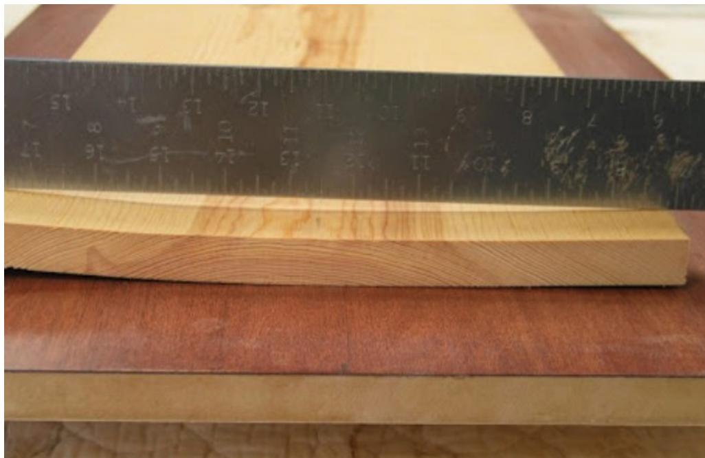
Рис. 1.7. Викривлення конструкційного елементу [31]
