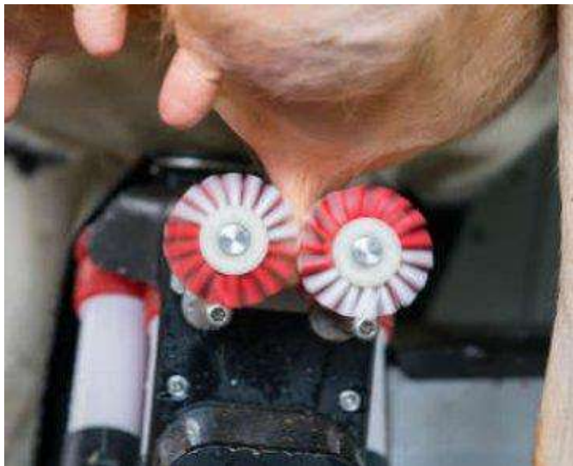
Рис. 4.3. Щітковий очисник Лелі Астронавт
