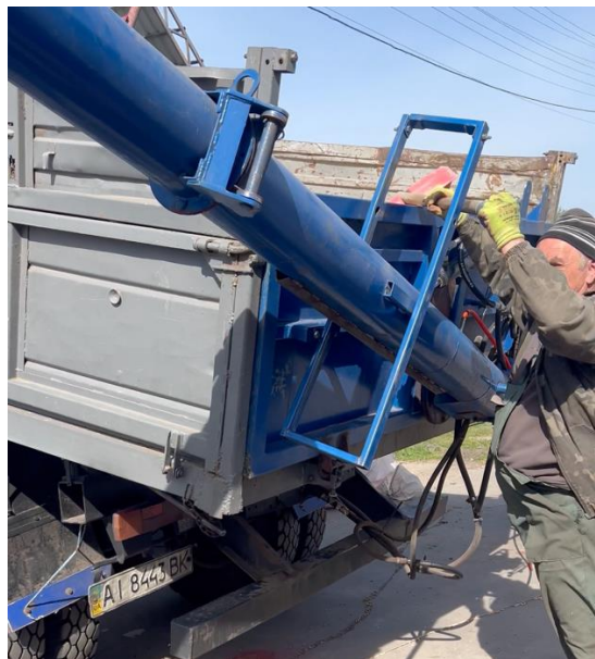
Рис. 3.2 Передпосівне протруювання посівного матеріалу сої за допомогою ПЗС-30 (сорт – Венус, ФГ «ВАЯК», Бориспільського р-н, Київської обл. 2025 рік) [Власне фото]
