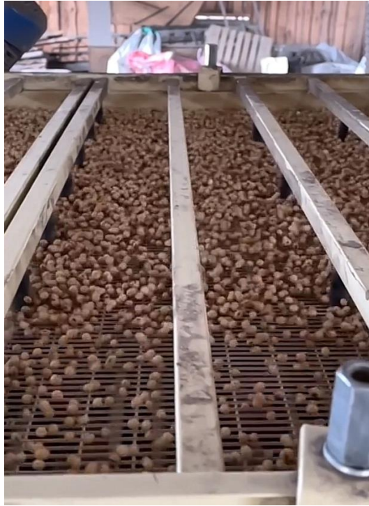
Рис. 3.1 Калібрування посівного матеріалу сої за допомогою приладу ОКМФ-2 (сорт – Венус, ФГ «ВАЯК», Бориспільського р-н, Київської обл. 2025 рік)
