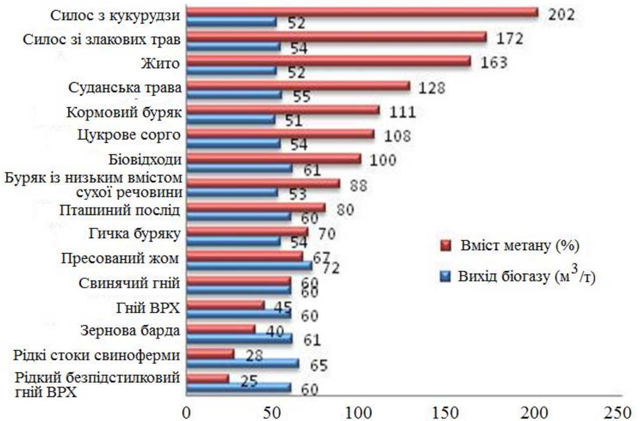
Рис. 1.2. Вихід біогазу для різних видів рослинної сировини та відходів тваринництва [30]
