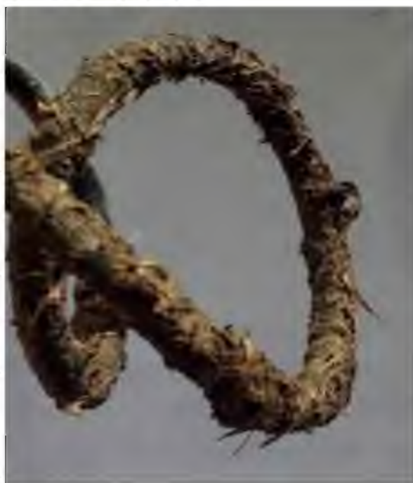
Рис. 3.3 - Відкладення на зовнішній стінці змійовик
