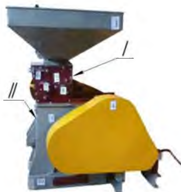
Рис. 3.10. Загальний вигляд двоступінчастого подрібнювача зерна I - вальцова секція подрібнювача; II - молоткова камера дробарки;
