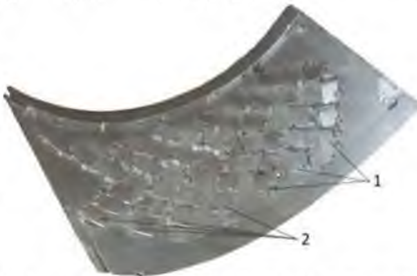
Рис. 3.10. Дека молоткового ступеня подрібнювача: 1 - розсіювальна секція, 2 - збиральна секція.
