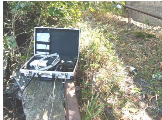
Рис. 2. Розміщення датчика вібрації на ґрунті для реєстрації віброприскорень
