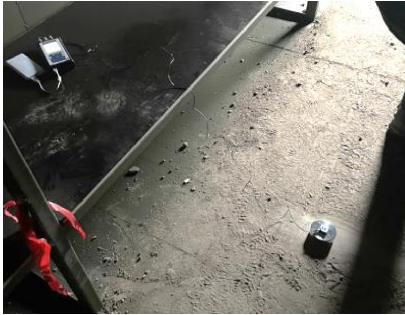
Рис. 2. Розташування трьохкомпонентного датчика вібрації
