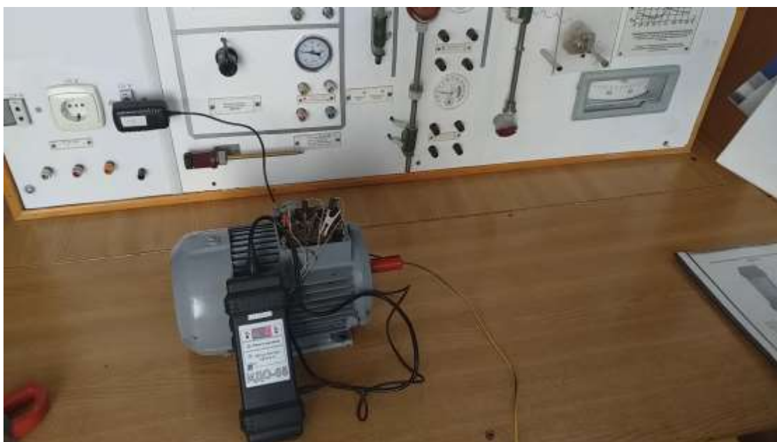
Рисунок 4.1 - Загальний вигляд експериментального стенда з асинхронним електродвигуном та пристроєм ІДО-05
