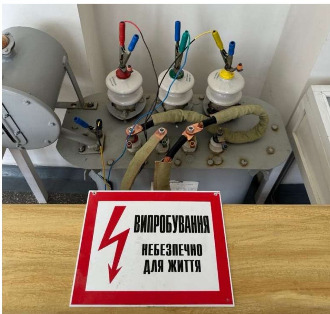
Рисунок 3.1 – Експериментальна установка для вимірювання активного опору обмоток трансформатора
