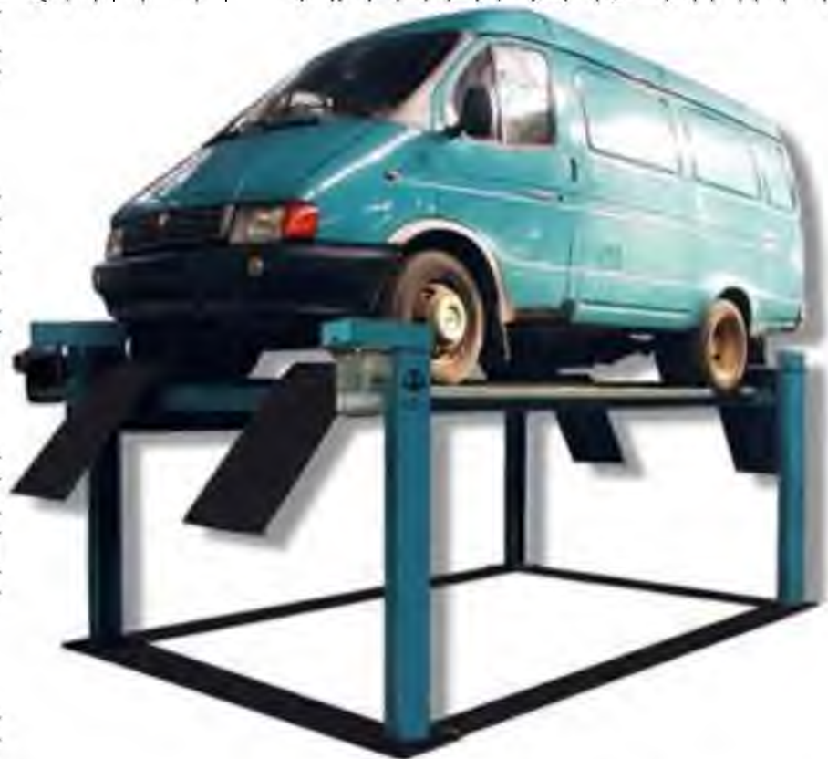
Рисунок 1.3 – Чотиристійковий підйомник ПП81.01
