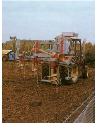
Рис.64. Використання механізмів для одночасного викопування садильної ямки та отвору у ґрунті під кілок.
