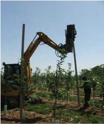
Рис.63. Гідравлічний стовпостав для високих опор.
