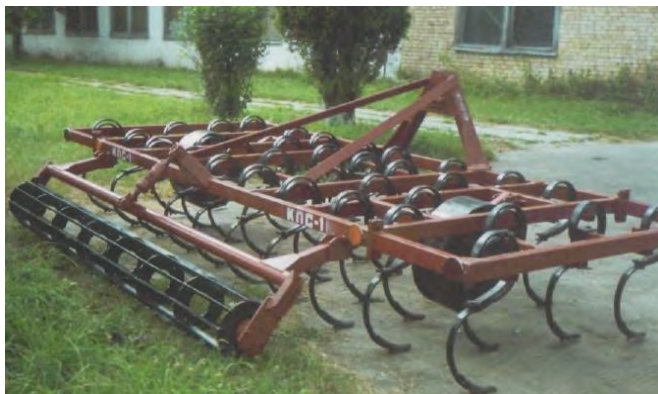
Рис. 51. Культиватор пружинний садовий КПС-1 для суцільного обробітку ґрунту в міжряддях саду і кущових ягідників.
