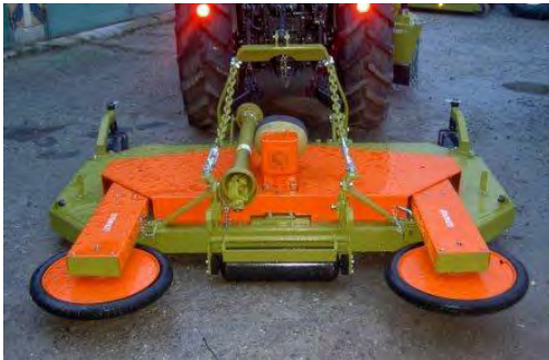
Рис. 68. Подрібнювач-косарка моделі HM4 (виробництва Чехії), одночасно з подрібненням одно-дворічних гілок, скошує траву в міжряддях і, за допомогою додаткових висувних косарок, у пристовбурних смугах.
