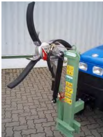
Рис. 74. Фреза моделі REAR для пристовбурної обробки в садах і виноградниках
