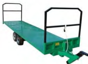
Рис. 85. Двохвісний причіп Розмір: 5100 x 1250 x 500 Макс. навантаження – 2500 кг
