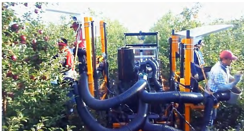
Рис. 81. Напівавтоматичний метод збору яблук.
