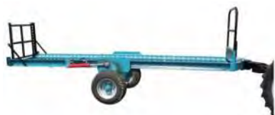
Рис. 82. Одновісний причіп для транспортування яблучних контейнерів Розмір: 3800 x 1250 x 800 Макс. навантаження – 1200 кг
