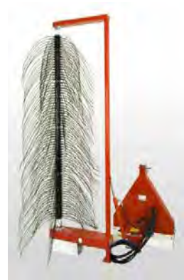
Рис. 41. Машина для проріджування квіток моделі DARWIN
