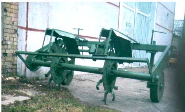
Рис. 52. Машина МНБ-2 для нарізування борозен при садінні підщеп у розсаднику.
