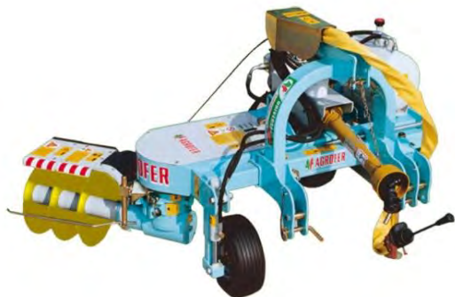
Рис. 74. Фреза моделі REAR для пристовбурної обробки в садах і виноградниках
