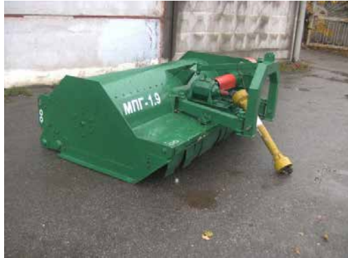
Рис. 58. Подрібнювач зрізаних гілок в інтенсивних садах (МПГ-1,9)
