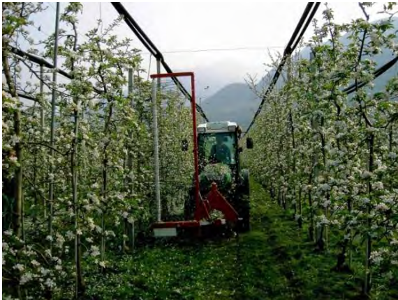
Рис. 41. Машина для проріджування квіток моделі DARWIN
