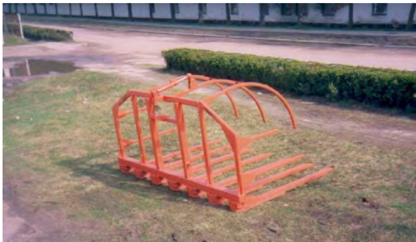
Рис. 49. Волокуша ВС-2,5 для збирання і вивезення зрізаних гілок в саду.
