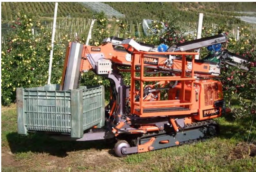
Рис. 78. Самохідна платформа для збирання фруктів Revo Piima Revolution Pianura (Італія).
