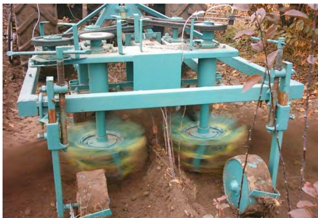
Рис. 55. Розкривач RBM-1 для відкриття кореневої системи маточних рослин.
