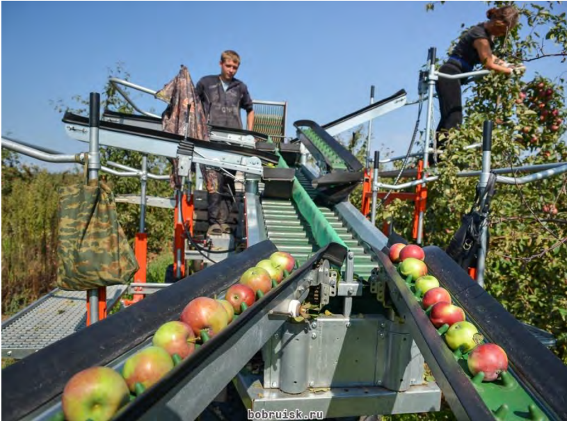
Рис. 77. Машина для механізації збирання фруктів серії ZAS
