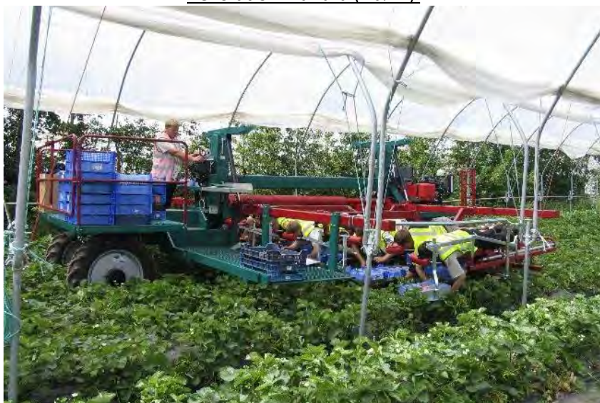
Рис. 79. Самохідний комбайн для збирання суніці.
