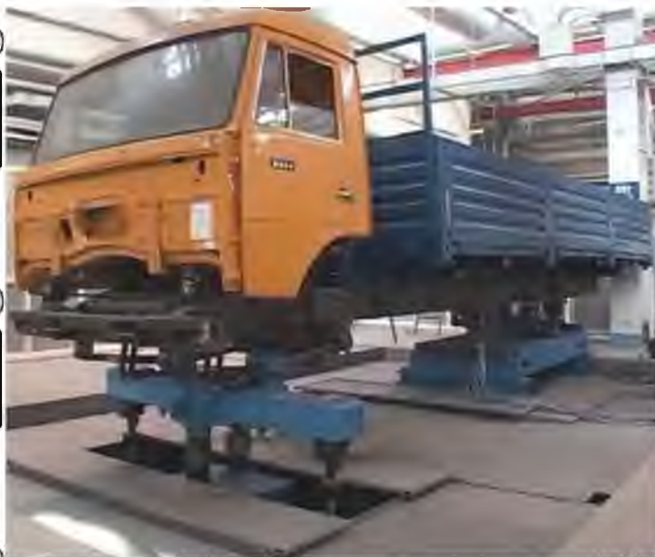
Рис. 4.1. Випробувальний стенд для дослідження динаміки конструкції транспортної системи
