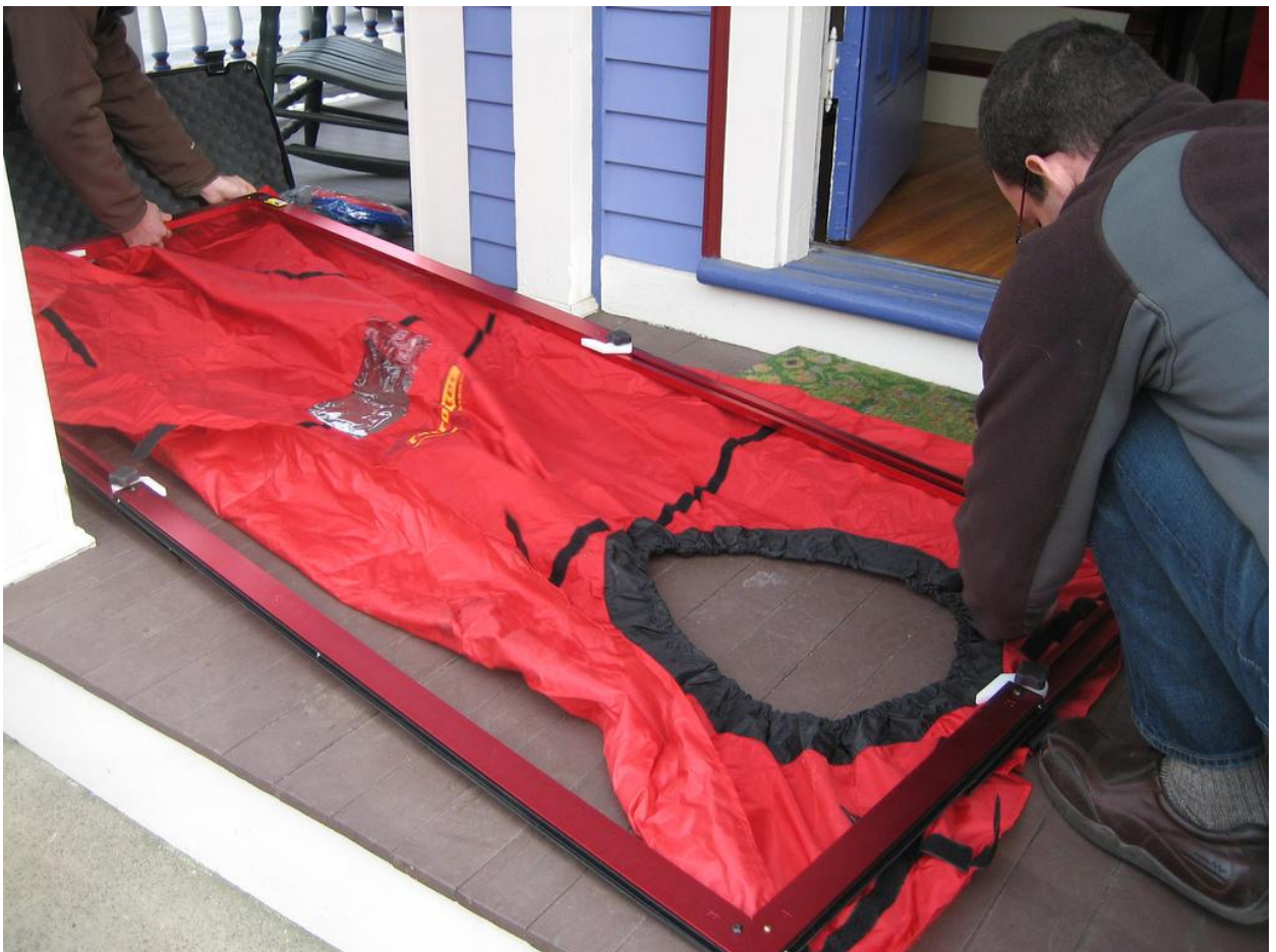
Рис. 1.3. Приклад підготовки аеродверей для встановлення в отвір вхідних дверей за допомогою знімної дверної панелі
