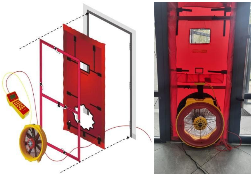
Рис. 3.2. Схема та зовнішній вигляд аеродверей
