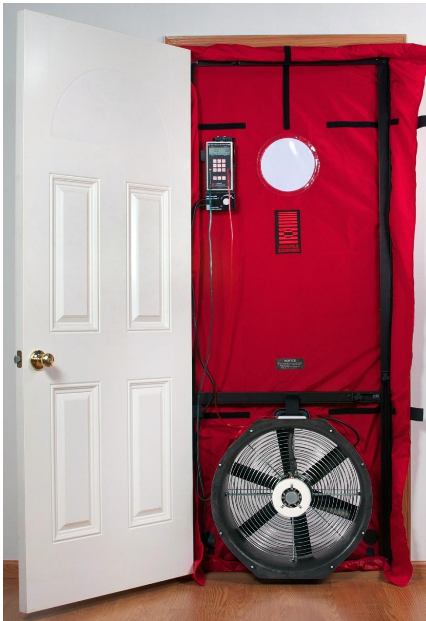
Рис. 1.2. Зовнішній вигляд сучасного комплекту обладнання (Аеродвері) для оцінки герметичності окремих приміщень або секцій будівлі
