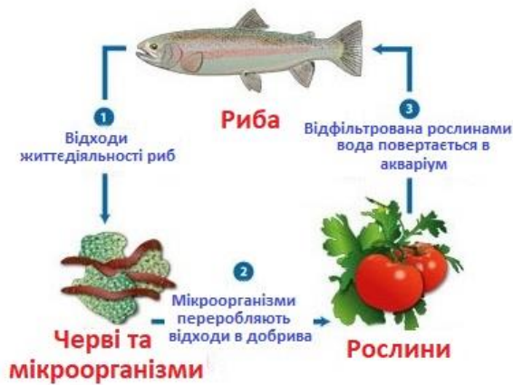
Рис. 2.8. Принцип аквапоніки (зліва) та аквапонна ферма, де вирощують овочі та рибу (справа)
