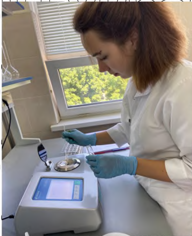
Рис. А.3.5 Визначення масової частки води на рефрактометрі
