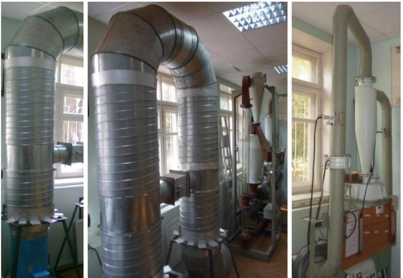
Рис. 3.1. Зовнішній вигляд експериментальної установки для дослідження кінетики процесу сушки жовткової суміші методом розпилення
