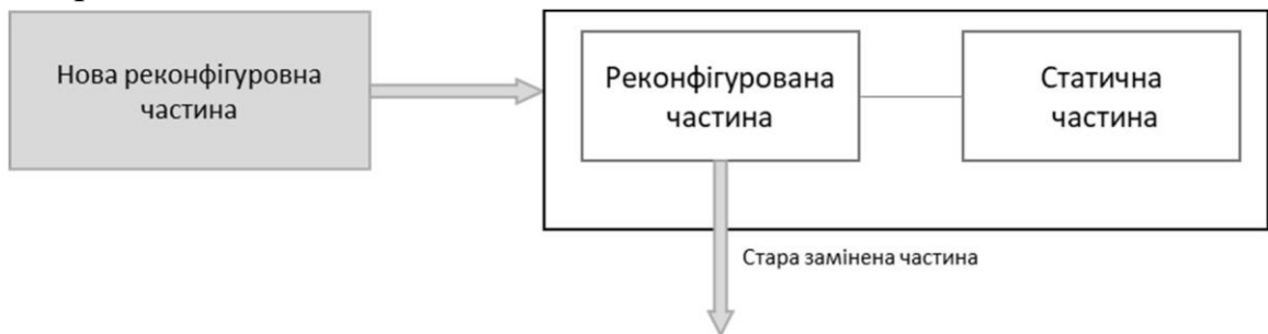
Рис. 3.7 – Концепція часткової реконфігурації FPGA
