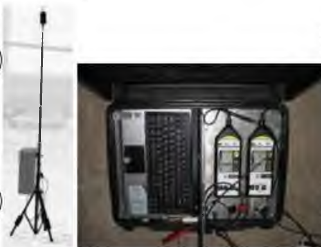
Рис. 1.5 – Система автоматизованого моніторингу шуму, обладнана шумомірами, комп'ютером та адаптером бездротової телеметрії по радіоканалу
