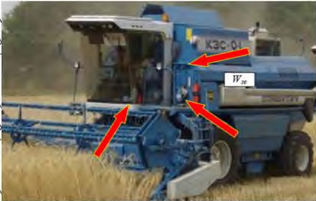
Рис. 2.14 – Основні потоки звукової енергії (показані стрілками) у працюючого комбайна КЗС-9-1 «Славутич», спрямовані на робоче місце оператора
