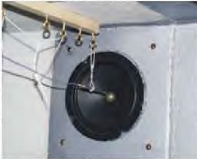
Рис. 2.8 – Гучномовець у камері Sound Brick моделює точкове джерело звуку
