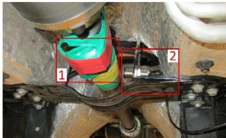
Рисунок 3.9 - Розташування датчика крутного моменту на задньому валу коробки передач: 1 - блок виносних деталей трансмісії; 2. Приймач сигналу
