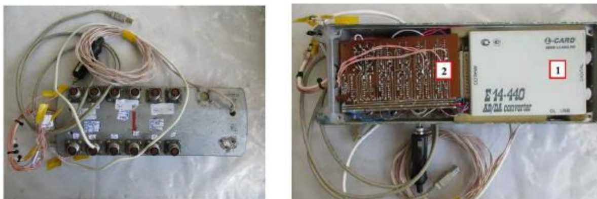
Рисунок 3.11 - Записуючий пристрій: 1 - L-плата АЦП E14-440; 2- БХГ
