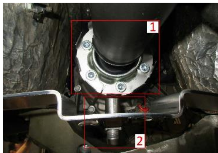
Рисунок 3.9 - Розташування датчика крутного моменту на задньому валу коробки передач: 1 - блок виносних деталей трансмісії; 2. Приймач сигналу
