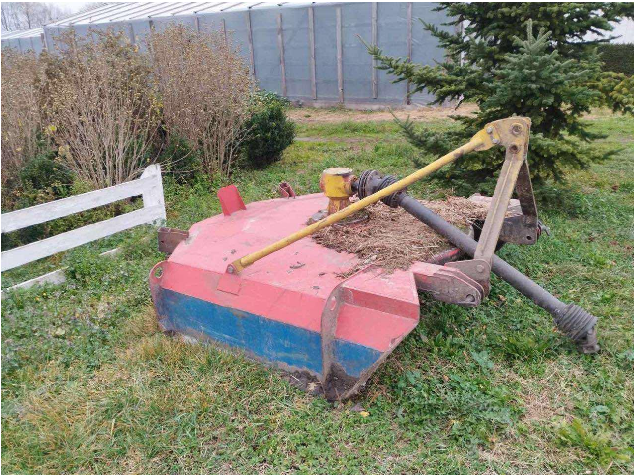
Рис. 4.9. Мульчувач Kansas-170, що використовується для проведення доглядів за лісовими культурами (фото автора)
