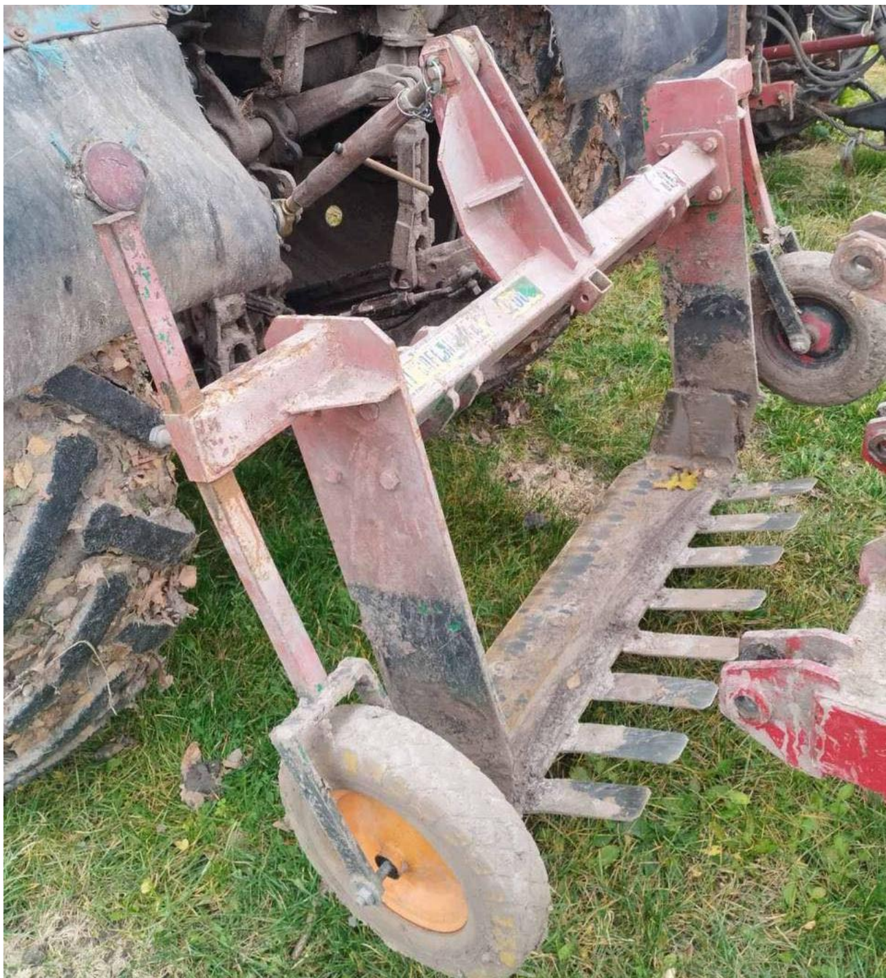
Рис. 4.4. Навісна скоба НВС-1,2, що застосовується у лісових розсадниках для викопування сіянців (фото автора)
