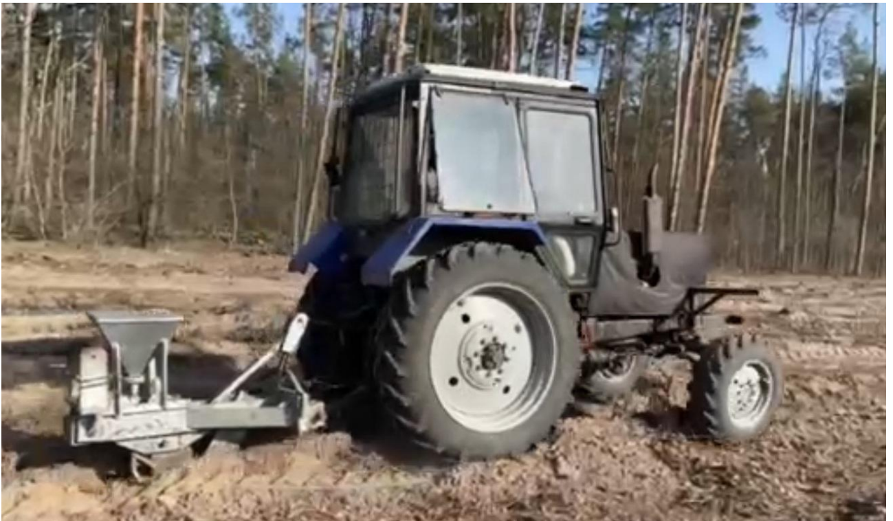
Рис. 4.12. Процес передпосадкового рихлення ґрунту із застосуванням навісного обладнання, що забезпечує одночасне внесення мінеральних добрив (фото автора)
