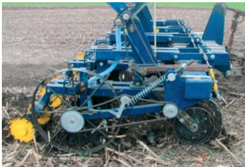
Рис. 1.8. – Агрегат для смугового обробітку ґрунту СТА-4Н виробництва СТВФ «Агрореммаш»
