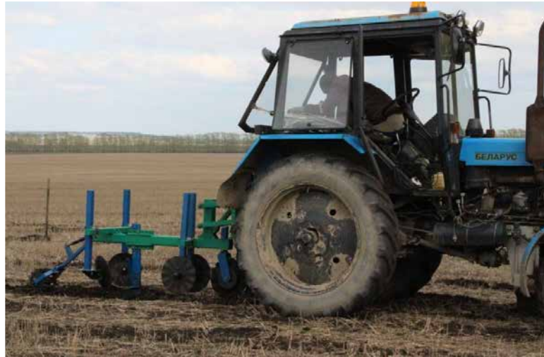
Рис. 3.1 - Випробування секції культиватора для смугового обробітку ґрунту в лабораторно-польових умовах
