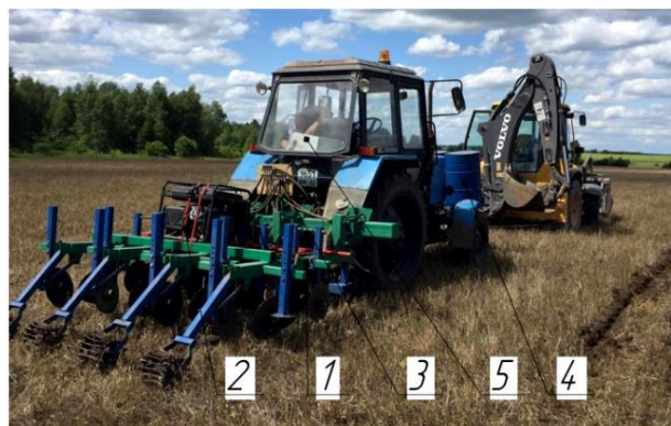
Рисунок 3.12 - Тягове випробування культиватора: 1 - культиватор; 2 - джерело живлення (бензиновий генератор); 3 - система подачі РКД; 4 - емність для РКД; 5 - вимірювальний комплекс МІС-400D
