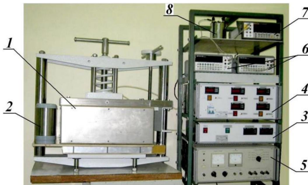
Рис. 4.6. Зовнішній вигляд системи PTMS: 1 – тепловий блок; 2 – термостат опорних спаїв термопар; 3 – електронний вимірювальний блок; 4 – силовий блок регуляторів; 5 – стабілізатор напруги постійного струму П4105; 6 – мультиметр цифровий Picotest; 7 – мультиметр цифровий Fluke 8846A; 8 – еталонна котушка електричного опору P310 [48].
