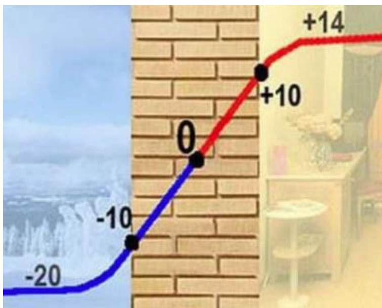
Рис. 1.1. Точка роси в будівлі без утеплення [3]
