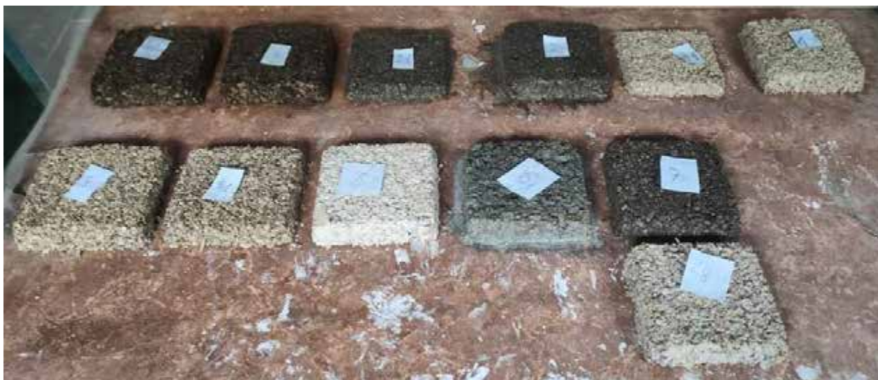
Рис. 4.4. Загальна кількість зразків першої партії: 1. Деревні частинки + вапно; 2. Деревні частинки + цемент; 3. Деревні частинки + цемент + пісок; 4. Деревні частинки + гіпс + вапно; 5. Деревні частинки + керамзит + вапно; 6. Деревні частинки + керамзит + цемент; 7. Деревні частинки + керамзит + цемент + пісок; 8. Деревні частинки + керамзит + гіпс + вапно
