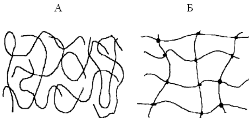
Рис. 1.32. Схема структури лінійного (А) і поперечнозшитого (Б) поліакриламіду
