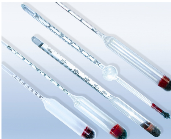
Рис. 1.1. Ареометри різних типів
